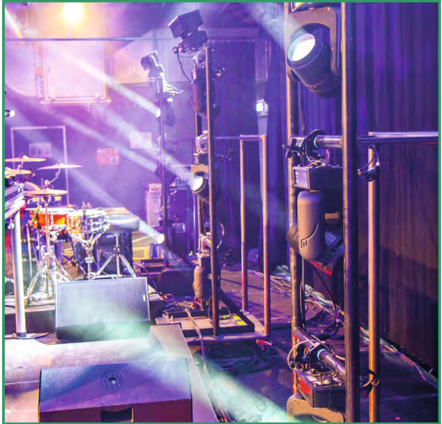
Für das Feeling und einige Musiker werden immer noch Monitor-Wedges auf der Bühne verwendet
