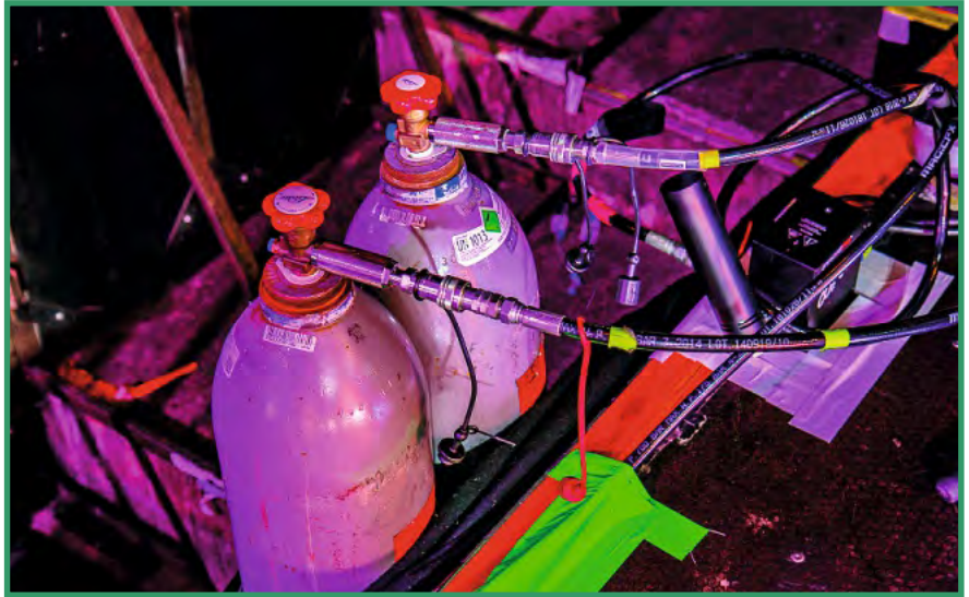
Die Druckluft-Flaschen neben der Bühne sind für das Kabuki-System vorgesehen
